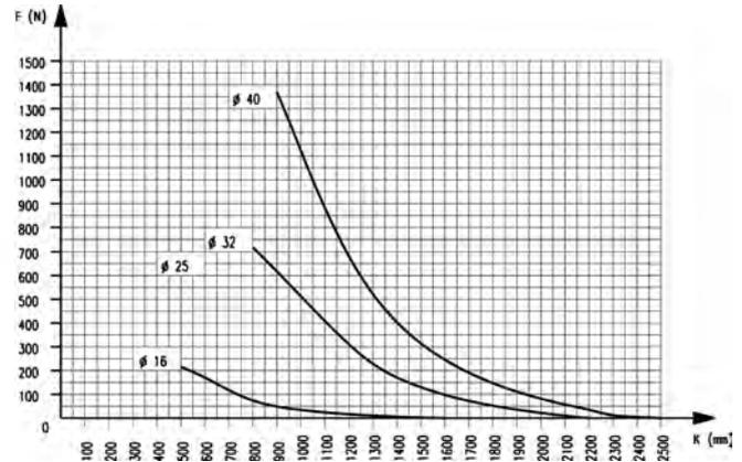
Прим.: Графики показывают максимально допустимые нагрузки для двуопорного варианта в случаях, при которых прогиб меньше 0,5 мм. Если действующая нагрузка превышает приведенные значения, то следует вводить дополнительную опору.
