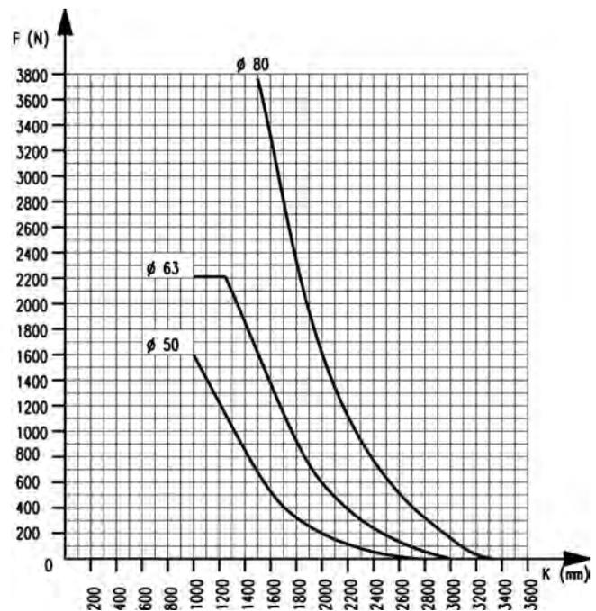
Прим.: Графики показывают максимально допустимые нагрузки для двуопорного варианта в случаях, при которых прогиб меньше 0,5 мм. Если действующая нагрузка превышает приведенные значения, то следует вводить дополнительную опору.
