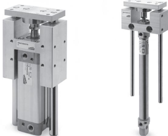
Направляющие Серии 45 были разработаны для предотвращения вращения штока пневмоцилиндра и для исключения радиальных нагрузок на штоке пневмоцилиндра.
